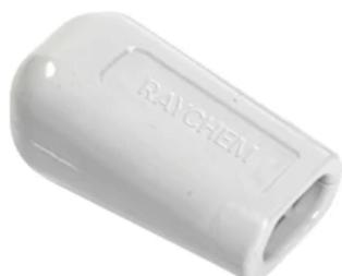
Les terminaisons nVent RAYCHEM RayClic-E-XX sont des terminaisons simples, rapides et fiables développées pour certains câbles chauffants autorégulants nVent RAYCHEM XL-Trace, IceStop et HWAT. Il n'est pas nécessaire d'utiliser des pistolets thermiques ou des pinces à dénuder, car la technologie de gel de silicone est utilisée pour électrifier le raccordement.
