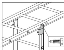
Dérivation verticale sous une autre échelle à câbles à l'aide d'une partie d'un accouplement 22 et une vis autotaraudeuse.
