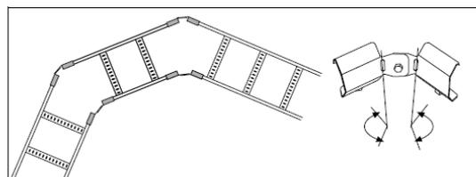
Les accouplements 22 sont utilisés pour tout changement de direction horizontal. L'angle est déterminé par la longueur coupée des longerons.
