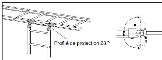
L'accouplement 22 est utilisé pour les dérivations verticales à tout angle. Utilisez le profilé de protection 28P (couper sur mesure).
