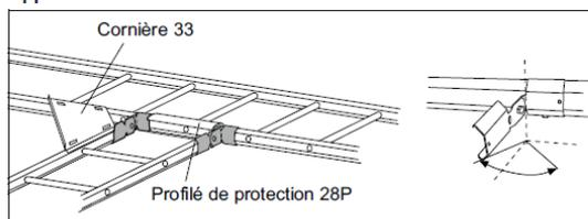
L'accouplement 22 est utilisé pour les dérivations horizontales à tout angle. L'angle est déterminé par la longueur coupée des longerons. Utilisez la plaque d'angle 33 et le profilé de protection 28P (couper sur mesure).
