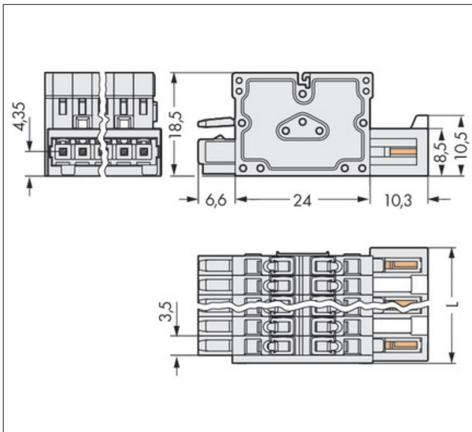
Aperçu d'impression: Barrette universelle; Sortie pour connecteur mâle et femelle; 4 pôles; Pas 3,5 mm / 0.138 in; 100% protégé contre l'inversion; avec possibilité de codage - Numéro d'article: 734-364
