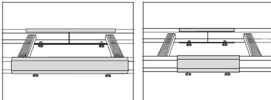
Utilisez l'accouplement 21 pour l'accouplement stable des échelles à câbles en ligne droite. Aussi pour l'accouplement des courbes, pièces en T, croisillons, pièces de montée et des échelles à monter verticalement.
