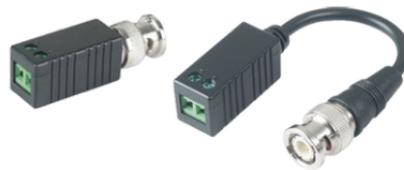
Kit passif de conversion du signal vidéo AHD sur câble UTP/ CAT5 et vice versa, connecteurs type BNC pour entrée/sortie du signal vidéo, cosses à vis pour la connexion du câble UTP/CAT5, distance pouvant être atteinte 200 m (HD) ou 100 m (FULL-HD)
